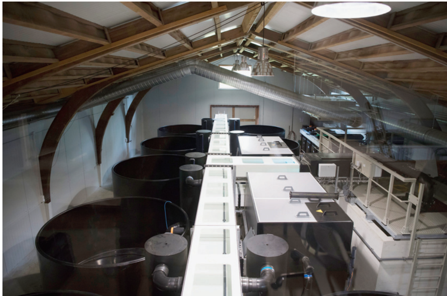
L'installation principale est composée de douze bassins où seront élevés quelque 12 000 sandres par année. DAVID MARCHON
